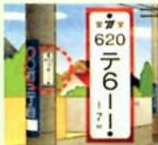
電柱の管理番号
